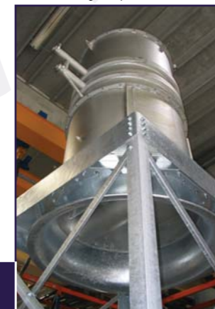
ADR 1400 in RVS met vaporizer en chassis volgens specificaties klant
