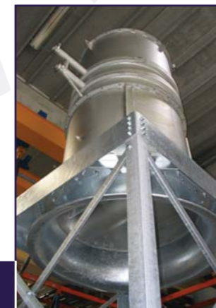
ADR 1400 en inox avec gicleurs et châssis selon les demandes du client
